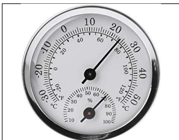
Thermomètre – hygromètre présent dans le local de mise en œuvre de l'activité
