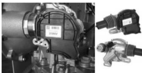
Boîtier VMU (Vessel Management Unit) (Repère 6)
