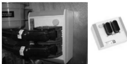
Boîtier VMU (Vessel Management Unit) (Repère 6)
